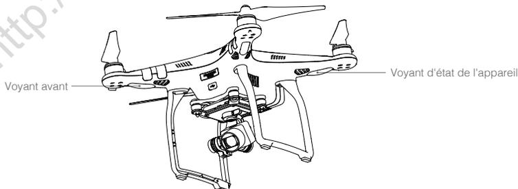
Les voyants avant s'allument en rouge fixe lorsque l'appareil est activé et vous permettent de l'orienter dans l'air. Vous pouvez désactiver les voyants avant dans l'application DJI GO pour obtenir un meilleur résultat lors des prises de vue. Les voyants d'état de l'appareil indiquent l'état du contrôleur de vol. Consultez le tableau ci-dessous pour en savoir plus sur les séquences de clignotement associées.
