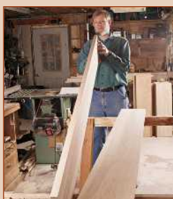
65 | Sélectionner les planches en fonction de leurs flèches et défauts
