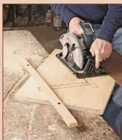
62 | Réaliser un gabarit d'entaillage des limons
