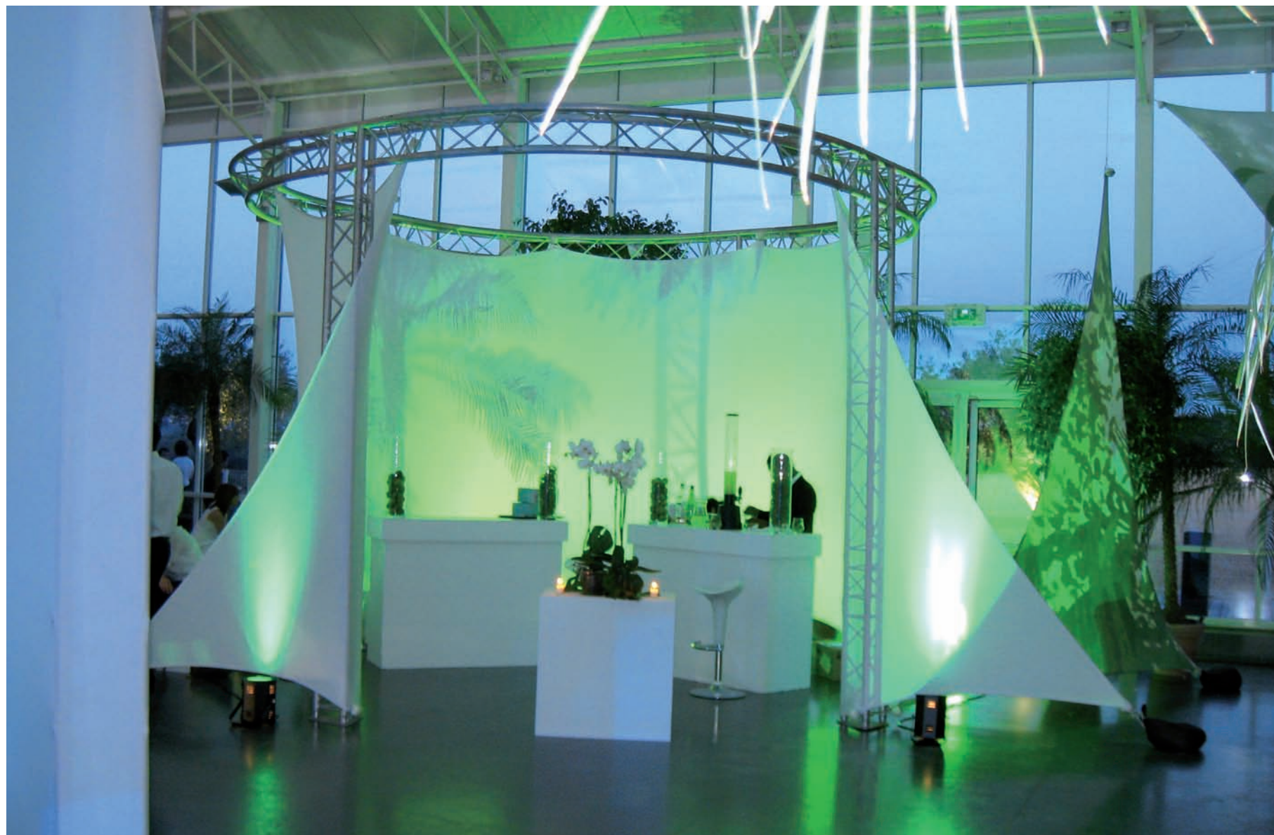
Une décoration éphémère avec une structure en Prolite et du Lycra. La Prolite permet de créer toutes sortes de structures, même circulaires. Mais sa mise en œuvre est lourde : ici son installation a mobilisé au moins 3 personnes et un dispositif de levage. On remarquera aussi le choix de la couleur des éclairages, qui renvoient à la nature et au bien-être.
