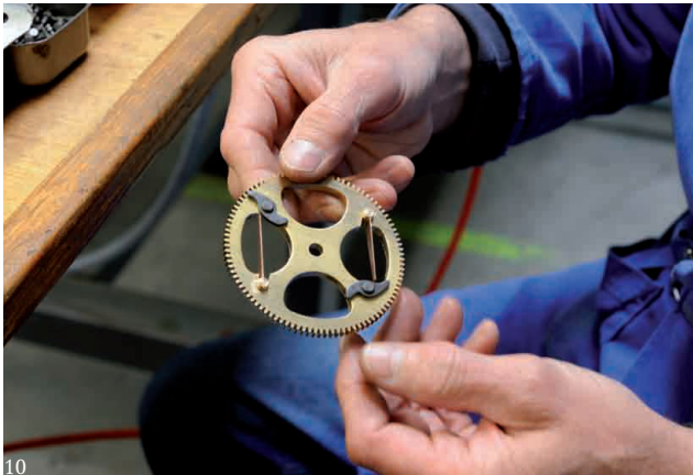
Fig. 10 La couronne est munie du système anti-retour.
