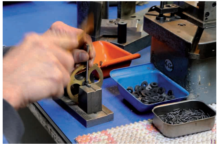
Fig. 10 La couronne est munie du système anti-retour.
