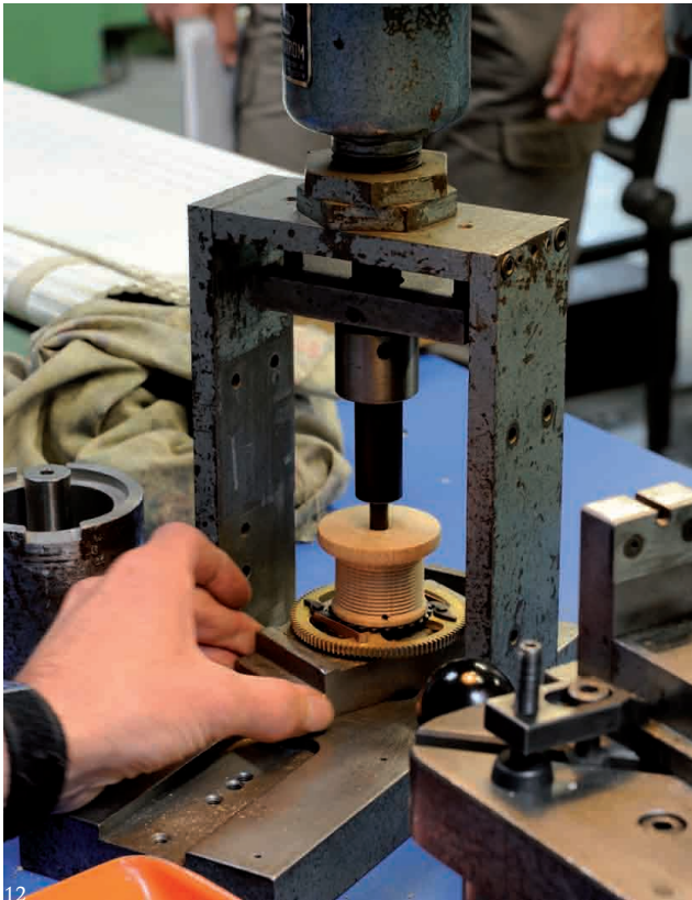
Fig. 11 L'opérateur monte un axe dans la couronne du barillet et y ajoute le rochet, une roue crénelée sur laquelle les cliquets se positionnent ; il place une rondelle et enfonce une goupille pour fixer l'ensemble du côté couronne. Notons que mettre deux cliquets au lieu d'un seul rend le système très solide.
