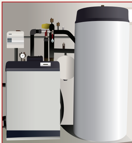
Exemple de chaufferie: pompe à chaleur Waterkotte + ballon d'eau chaude sanitaire
