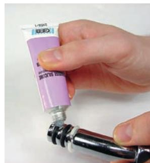
3 - Enduisez les joints de graisse au silicone, puis remontez.
