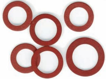
*Les joints en fibre vulcanisée sont les plus utilisés pour les raccords par serrage mécanique. Ils sont adaptés pour une eau allant jusqu'à 80 °C.*
