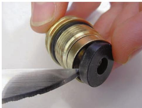
5 - Retirez le clapet avec une pointe de couteau.
