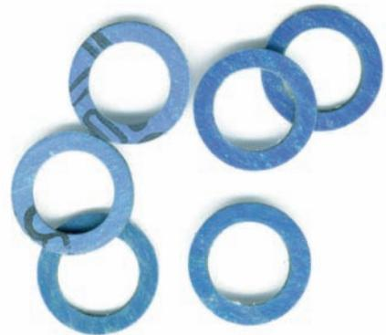
*Les joints CNK sont composés de kevlar® sans amiante. Ils peuvent être utilisés pour l'eau, la vapeur, le gaz... et sont agréés Gaz de France. Ils résistent à une température de 400 °C jusqu'à 100 bars.*
