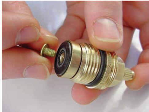
4 - S'il y en a une, retirez la vis de fixation.
