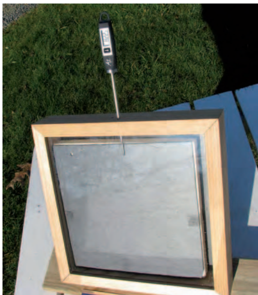
Absorbeur ardoise sous vitrage
