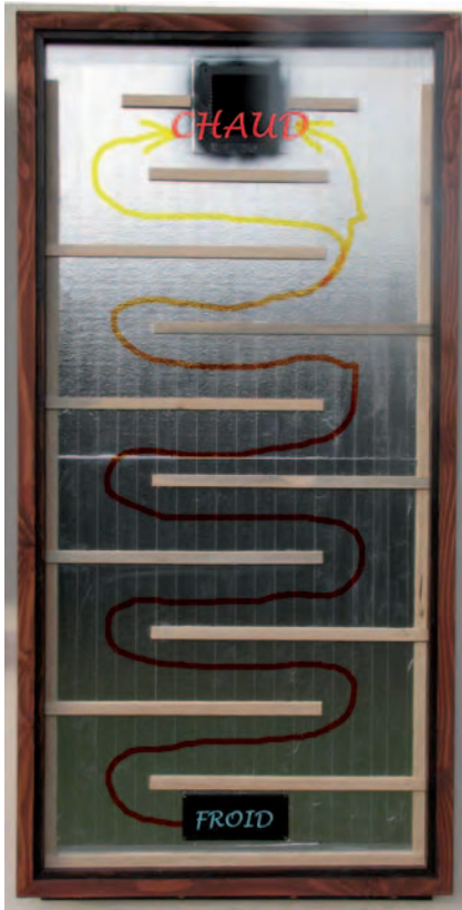
Disposition des chicanes sous l'absorbeur
