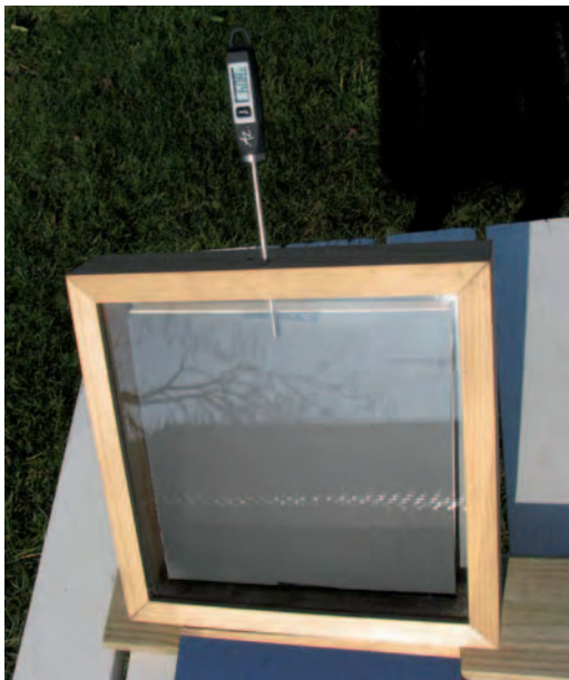
Absorbeur aluminium sous vitrage
