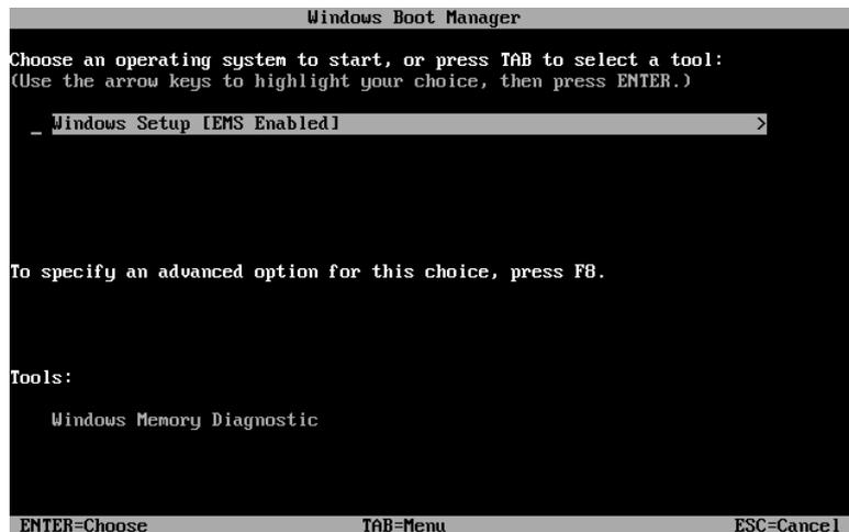
Un menu se présente. La touche <TAB> permet de basculer dans la rubrique outils et de diagnostiquer la mémoire. L'intérêt de ce type de test est d'éliminer ce type de problème lors de votre tentative de récupération avancée.
