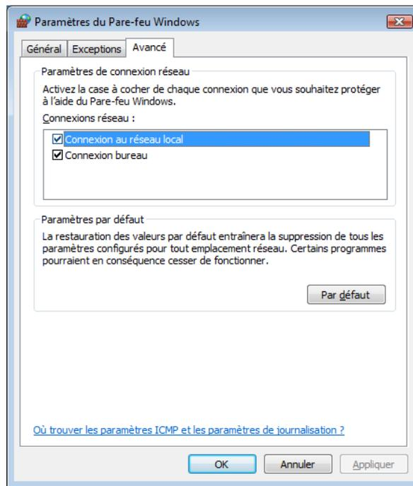
Enfin l'onglet Avancé sert à activer ou désactiver le pare-feu sur les différentes connexions réseau existantes sur l'ordinateur. Dans notre exemple, nous avons une connexion au réseau local et une connexion via VPN.
