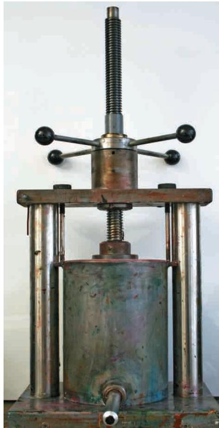
*Mise en tube de la couleur avec une machine à piston manuelle.*
