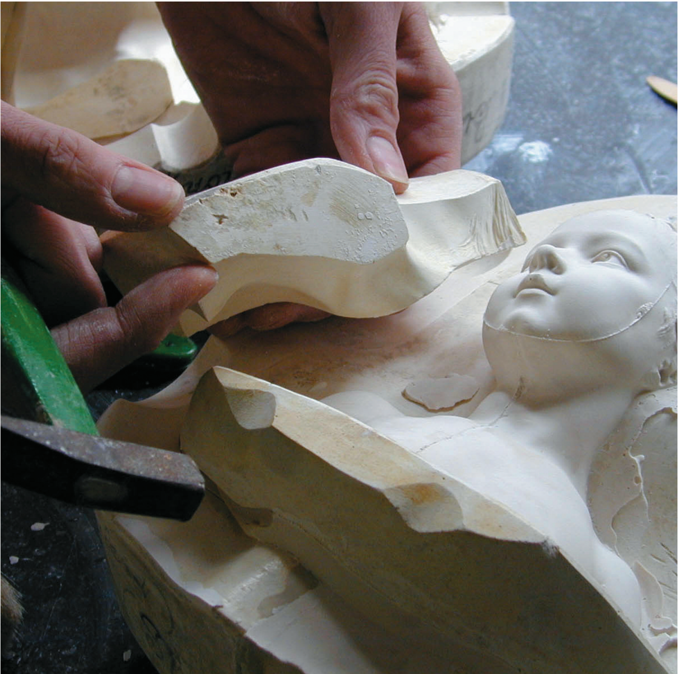
Un petit coup sec avec un marteau sur chaque pièce permet de les séparer avant de démouler (Manufacture de Sèvres).
