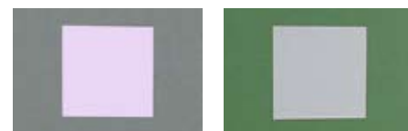
Comment un carré gris neutre sur fond vert simulant le feuillage se transforme avec certains appareils.
